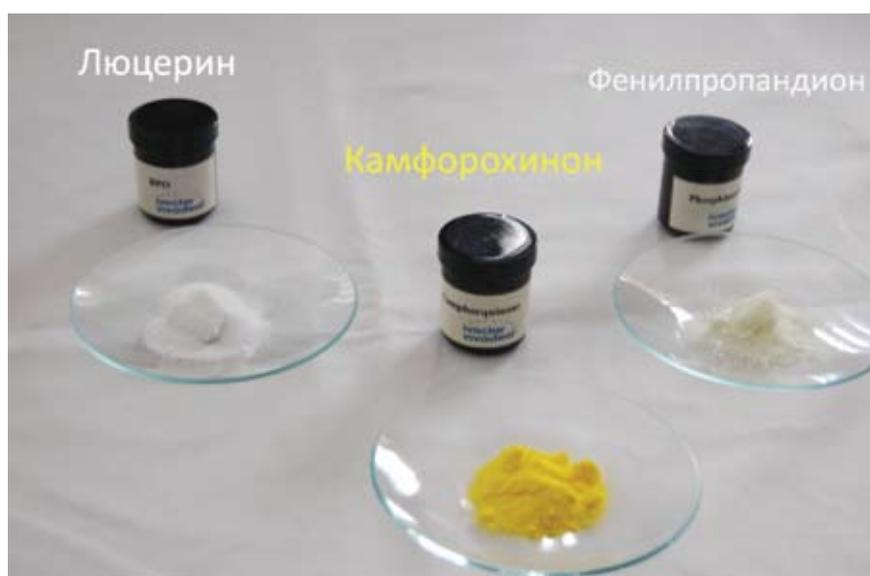
Рис. 2. Фотоинициаторы, используемые в фотокомпозитах
